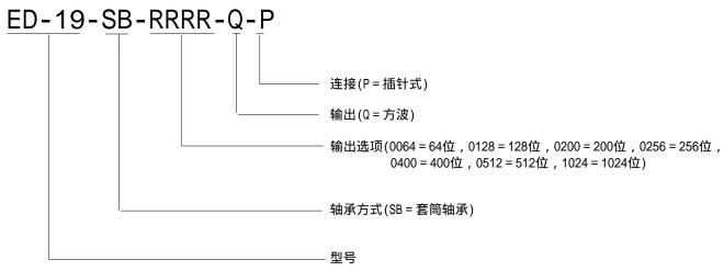
选型示例: ED - 19 - SB - 0064 - Q - P: ED - 19系列,套筒轴承,64位分辨率,方波输出,插针式。
