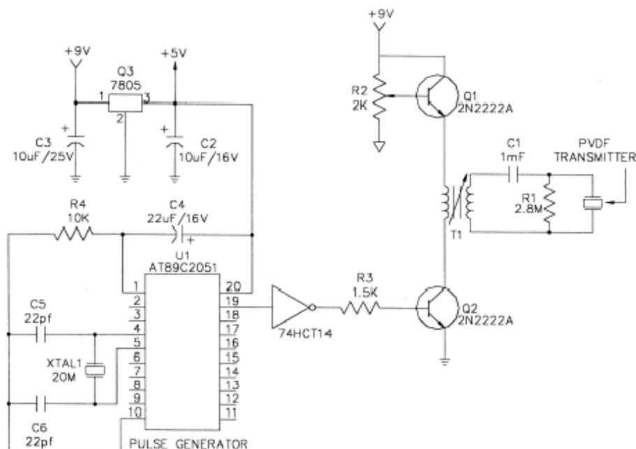
此驱动电路是用一定数目的脉冲驱动 40kHz 或 160kHz 的 PVDF 发射器。不同的应用采用不同数目的脉冲。
