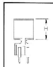
**发射器外壳设计：**机芯是 PVDF 圆柱的机械支撑。机芯的设计对谐振频率和水平波束角的一致性有很大的影响。建议在 PVDF 圆柱和机芯间至少有 0.5mm 间隙,如下所示。若间隙小于 0.3mm, 谐振频率开始增加。建议不要将 PVDF 圆柱的顶部和底部边缘刚性地固定, 如果两端刚性地固定,当 PVDF 暴露于高温下时会产生变形。如果保护罩是需要的, 正确的设计保护罩以最大限度的保证波束的一致性是非常重要的。通过保护罩结构的声场干扰是很难用理论计算预测的,因此,需要通过试验来设计。
